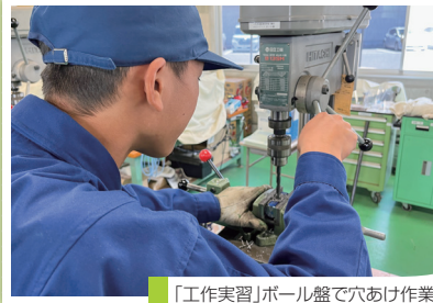
「工作実習」ボール盤で穴あけ作業
